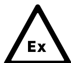
Figura 0B - Señal de advertencia para las zonas de riesgo de explosión - Directiva 99/92/CE
